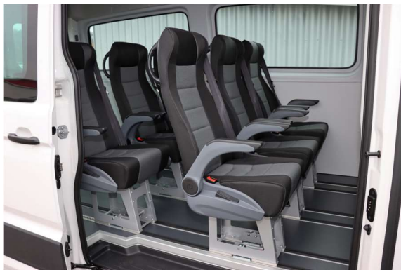
Die Umbau-Version «Comfort» glänzt mit abklappbaren Armlehnen und elektrisch ausfahrbarer Trittstufe.
