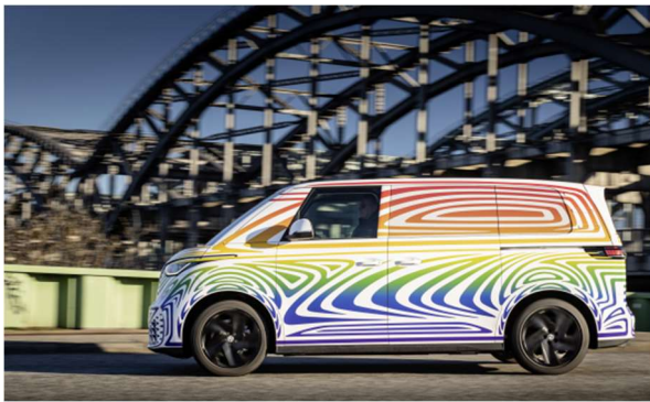
Extrem kurze Karosserieüberhänge ergeben einen maximal nutzbaren Raum auf einer minimalen Verkehrsfläche.
