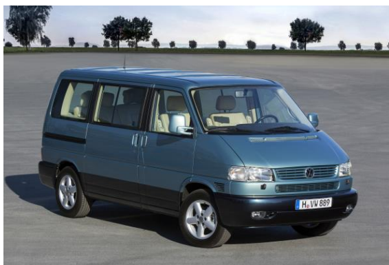
Il T4 è stato il primo Bulli con motore e trazione anteriori.
