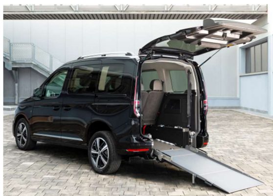
La persona in sedia a rotelle può accedere comodamente al veicolo tramite una rampa estraibile ripiegabile verso l'interno.
