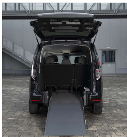
L'abbassamento del pianale e l'integrazione di una speciale vasca antiscivolo hanno consentito di raggiungere un'altezza degli interni di 140 cm.
