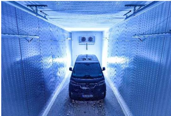
Test standardisé en chambre froide: Par moins 20 degrés, combien de temps faut-il pour que le champ de vision du rétroviseur extérieur soit dégagé?
