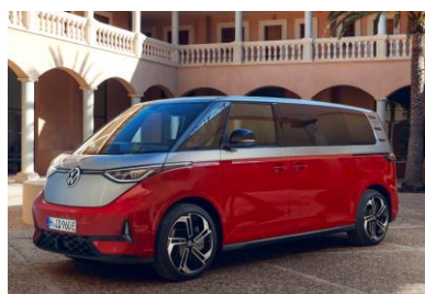
Il nuovo ID. Buzz GTX: trazione integrale di serie con un motore elettrico sull'asse anteriore e uno sull'asse posteriore.
