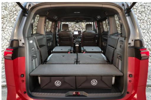
Il Multiflex Board offre un secondo piano di carico e, con i sedili posteriori ribaltati, una superficie di carico piana.
